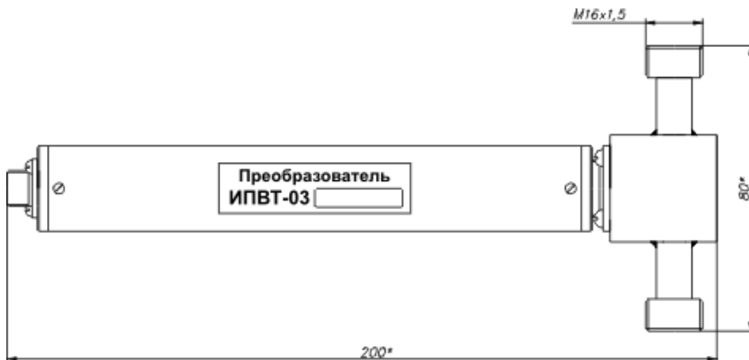
Рисунок А2 Измерительный преобразователь ИПВТ-03-03-ПВ(-ПС)
