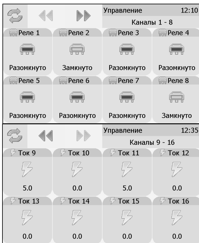
Рисунок 6.15 Вид экрана состояния каналов управления
