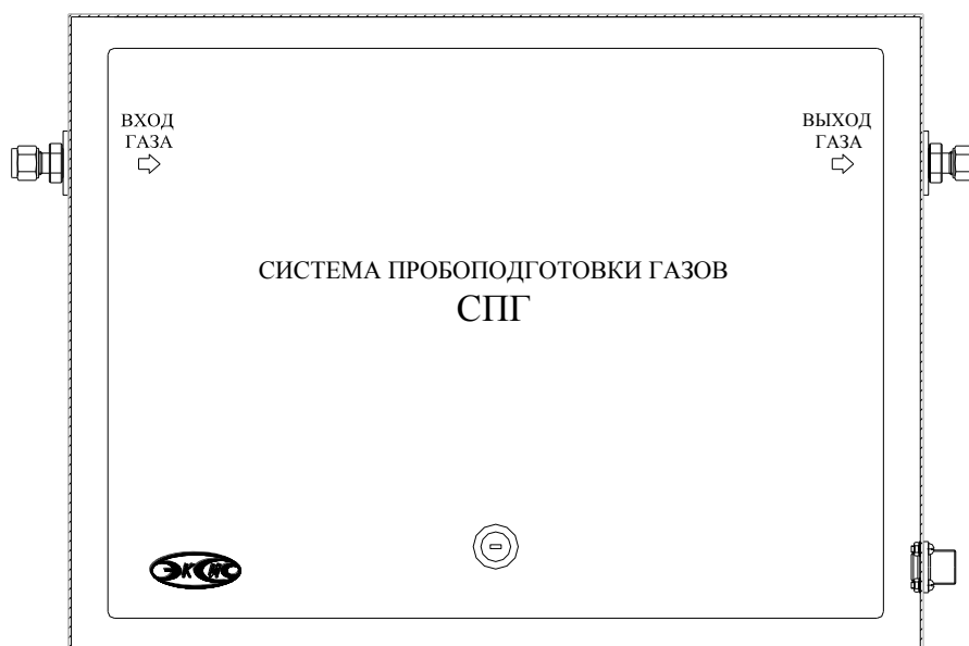
Рисунок 3.17 Внешний вид системы пробоподготовки газов
