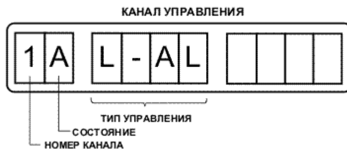
Рисунок 28 Канал управления при контроле состояния объекта
