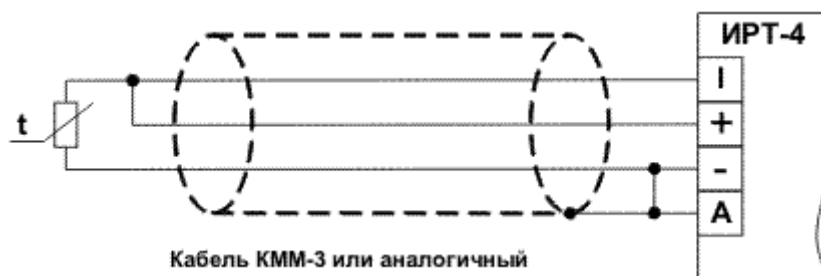
Рисунок 3 Трехпроводная схема подключения ТС
