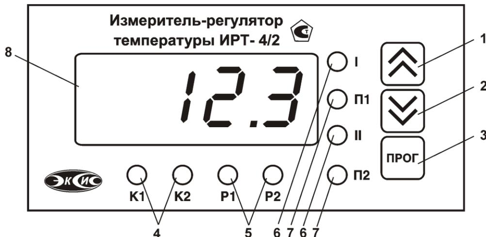
Рисунок 3.1 Передняя панель прибора
