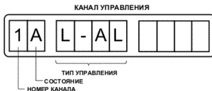
Рисунок 28 Канал управления при контроле состояния объекта
