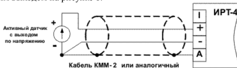
Рисунок 7 Подключение активного датчика с выходом по напряжению
