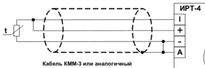
Рисунок 3 Трехпроводная схема подключения ТС
