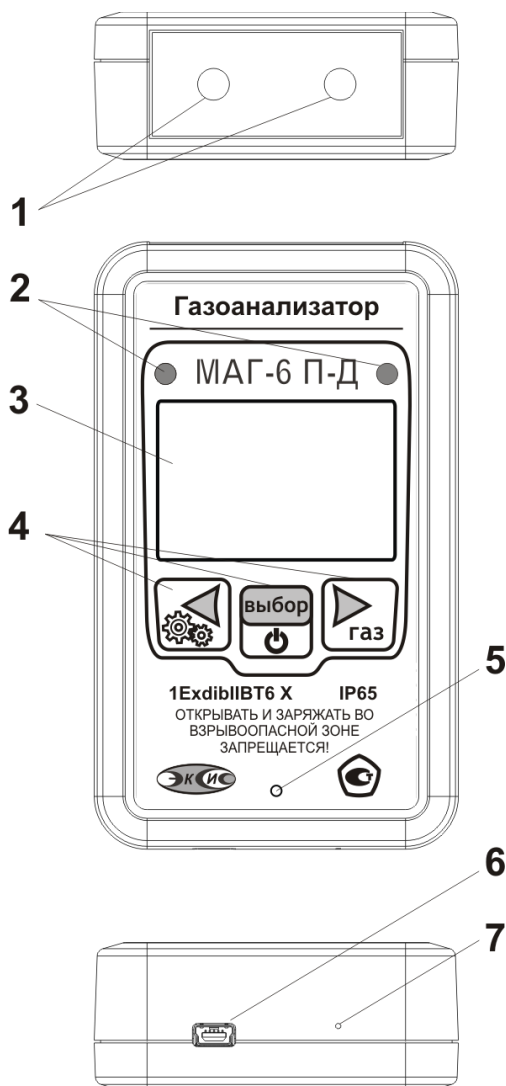
Рисунок 3.1 Переносной многокомпонентный газоанализатор МАГ-6 П-Д
