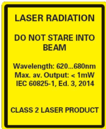
Der im **Scatec-2** eingebaute Diodenlaser sendet sichtbares rotes Licht aus. Gemäss der Norm IEC 60825-1 / 2014 gehört dieser Laser zur Laserklasse 2.
