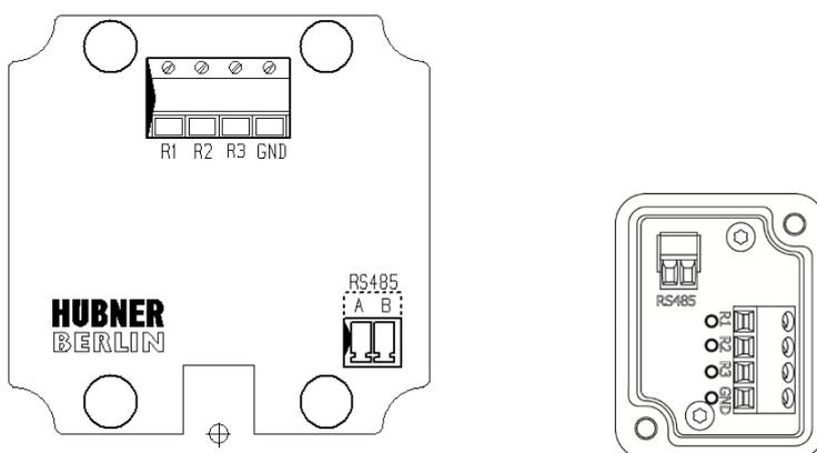
Bild 19: Belegung Klemmenkasten DSL.R
