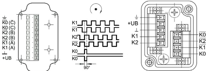
Bild 17: Belegung Klemmenkasten POG/HOG
