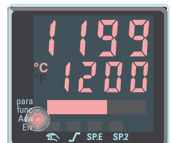
После успешной автоподстройки, светодиод  $AdA$  гаснет и контроллер продолжает работать с новыми параметрами управления.
