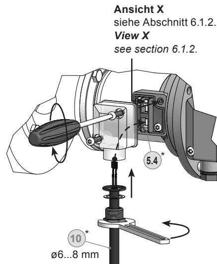
Zur Gewährleistung der angegebenen Schutzart sind nur geeignete Kabeldurchmesser zu verwenden.
