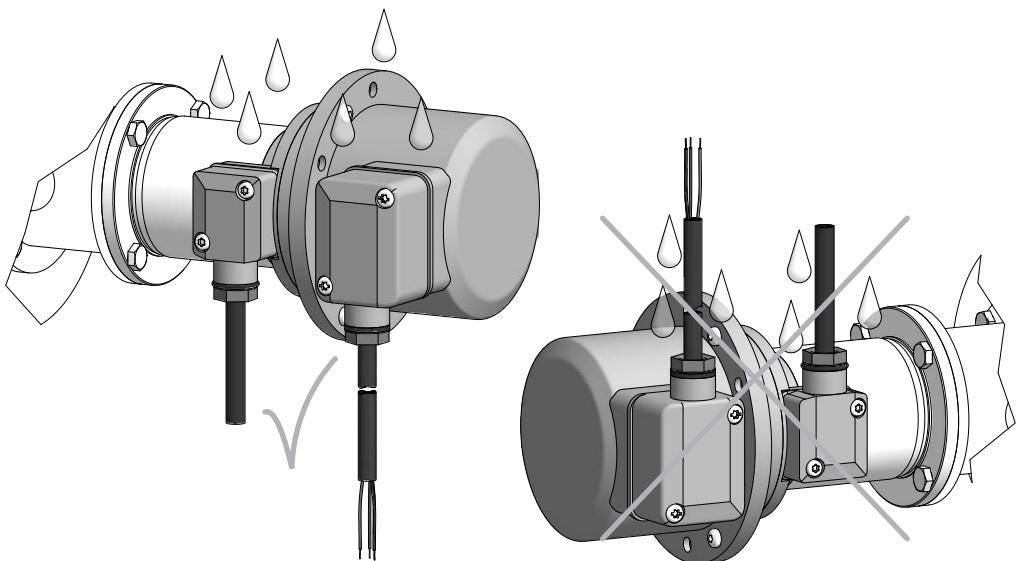
**i** Wir empfehlen, das Gerät so zu montieren, dass der Kabelanschluss keinem direkten Wassereintritt ausgesetzt ist.
