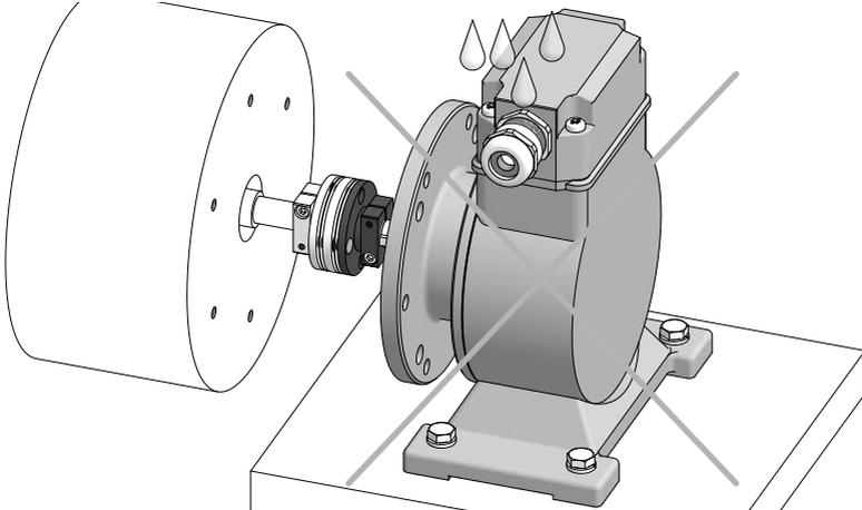
**i** Wir empfehlen, das Gerät so zu montieren, dass der Kabelanschluss keinem direkten Wassereintritt ausgesetzt ist.
