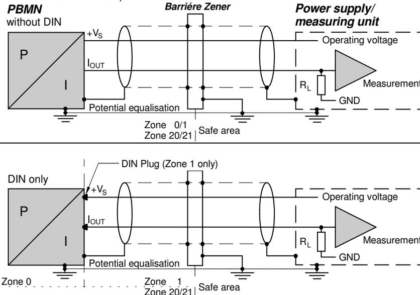
Betriebsspannung / supply voltage / tension d'alimentation.....Vs : 8...30 VDC
