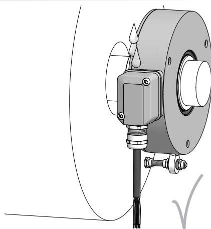
**i** Wir empfehlen, das Gerät so zu montieren, dass der Kabelanschluss keinem direkten Wassereintritt ausgesetzt ist.
