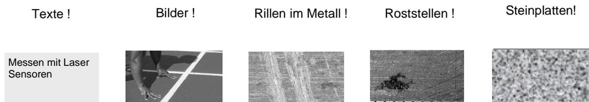
Werden solche Objekte quer zum Sensor bewegt, wird der Laserspot am Empfänger nicht überall gleichmässig abgebildet. Das erzeugt an jedem Übergang von Dunkel (Matt) nach Hell (Glänzend) oder umgekehrt eine Messabweichung ins Positive und dann ins Negative (oder umgekehrt).
