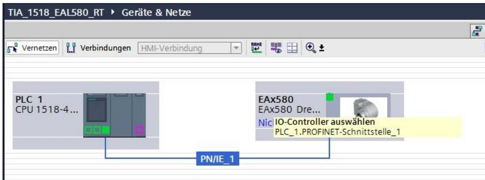
Anklicken der Schrift „nicht zugeordnet“ öffnet die verfügbaren Controller-Verbindungen. Nach Anklicken der Verbindung (in diesem Beispiel „PLC\_1.PROFINET-Schnittstelle\_1“) verbindet sich der Drehgeber mit der SPS.
