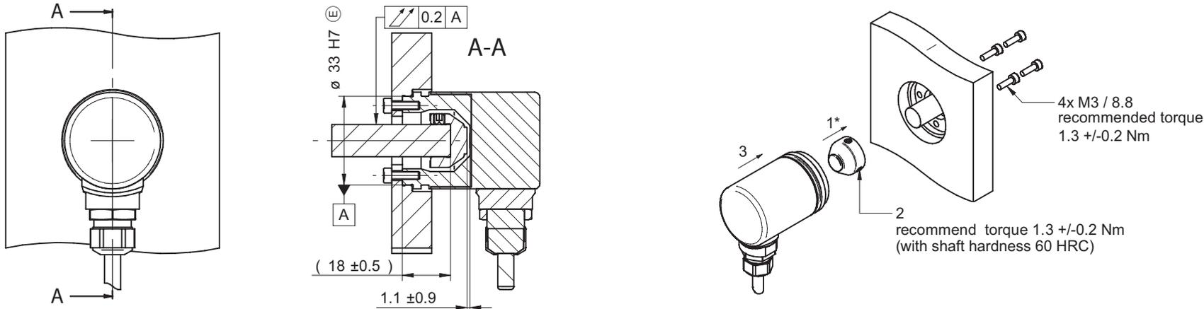
Magnetläufer und Drehgeber nicht separieren, sondern sofort montieren.
