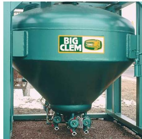
IV. Пескоструйная установка **BIG CLEM 5700** литров контейнерного типа (высота и ширина равны размерам 20 футового контейнера) на 4-х опорах с «карманами» для вил погрузчика. Установка комплектуется для работы 4-х операторов и включает в себя следующее:
