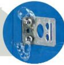
Пузырьки указывают на утечку воздуха. Относительную серьезность утечки можно оценить исходя из размеров и скорости образования пузырьков.
