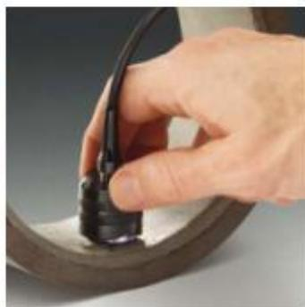
Разнообразные Датчики для измерения толстых покрытий, например, огнестойкие отделки, внутренняя облицовка резервуара и т.п.
