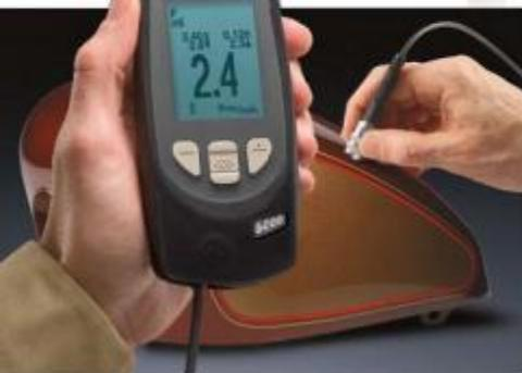
Стандартная модель показана в режиме Статистики с амортизационным корпусом из защитной резины
