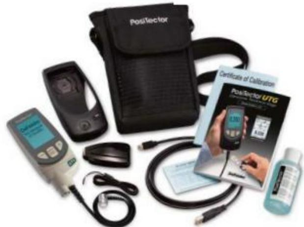
**В КОМПЛЕКТ ВСЕХ ПРИБОРОВ ВХОДИТ:** прибор и датчик, связующее вещество, защитный резиновый чехол, клипса на пояс, ремешок на запястье, 3 щелочные батареи типа AAA, инструкции, нейлоновый кейс с ремнем на плечо, защитные экраны на дисплей, Сертификат калибровки в соответствии с NIST, USB кабель, аккаунт PosiTector.net, гарантия на два (2) года.
