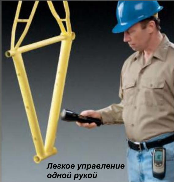
Работа прибора основана на технологии низкочастотного ультразвука, что позволяет производить измерения без непосредственного контакта датчика с поверхностью изделия и автоматически рассчитать и отобразить толщину покрытия.
