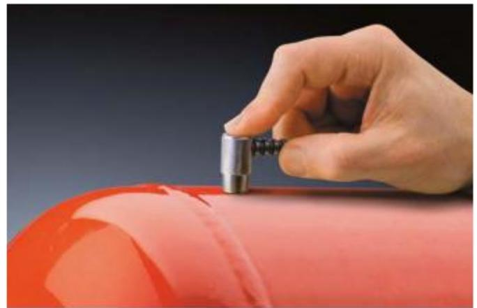
Датчик многочисленных отражений UTG M Thru-Paint измеряет толщину окрашенных конструкций без удаления покрытия.
