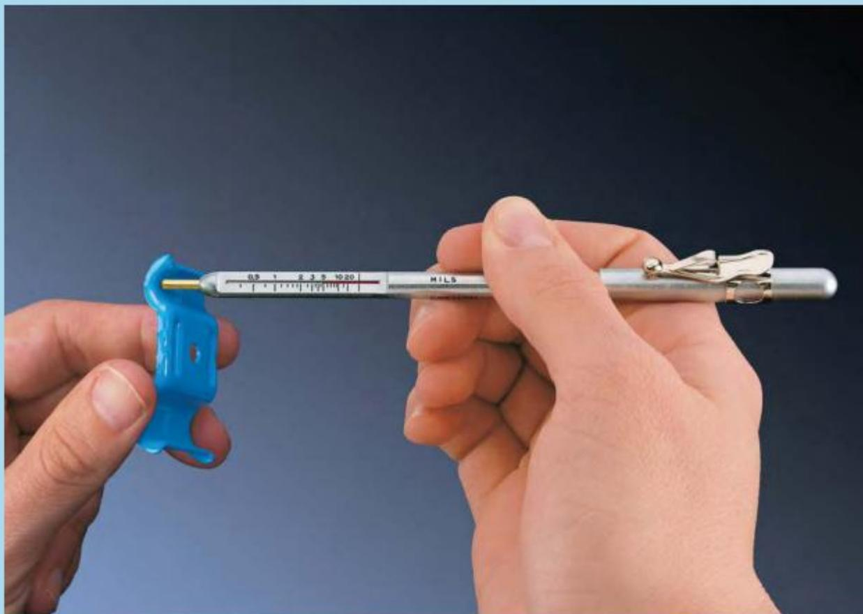
Измеряет немагнитные покрытия, такие как краска, эмаль, металлические покрытия, горячеоцинкованная сталь
