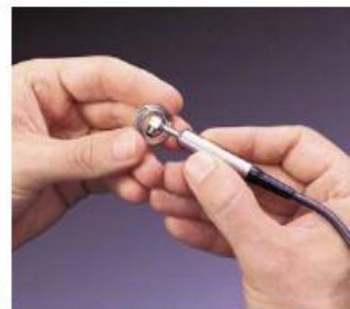
Серия Микродатчиков для измерения маленьких деталей и деталей с трубным доступом
