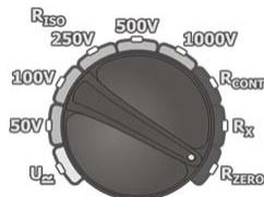
Установите поворотный переключатель в режим  $R_{ZERO}$
