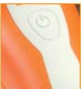
Если оператор крепко не сжимает рукоятку Elcometer 266, она отключается двойным защитным выключателем.
