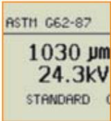
Встроенный калькулятор напряжения позволяет обходиться без таблиц пересчета. Введите стандарт испытания и толщину покрытия, и прибор автоматически установит требуемое напряжение.
