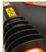
Расширенное ребрение, разработанное для соответствия стандарту EN61010, обеспечивает дополнительную защиту оператора. Теперь высоковольтная дефектоскопия стала еще безопаснее.
