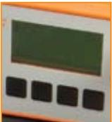
Большой дисплей с подсветкой позволяет легко считывать данные даже в затемненных местах. При обнаружении дефекта подсветка дисплея мигает.
