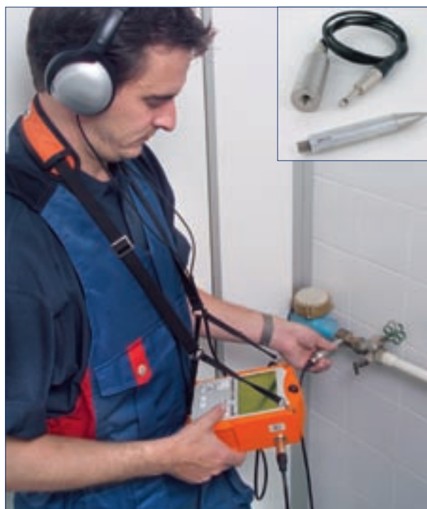
Поиск утечек в помещениях в труднодоступных местах может осуществляться при помощи микрофона EM 30 с коротким щупом.
