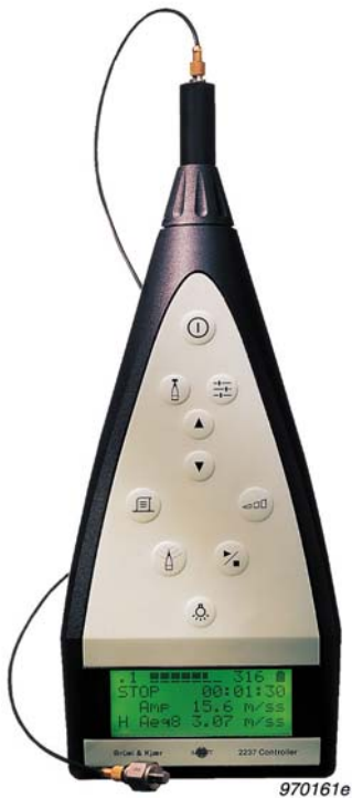
2239В с подсоединённым акселерометром.
