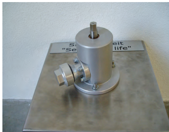
Устройство для откачивания газа смонтировано на поверхности и готово для сверления
