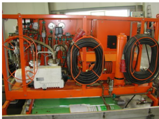
До модификации/ретрофита: старая сервисная тележка с вакуумным компрессором откачивание газа до 50 мбар
