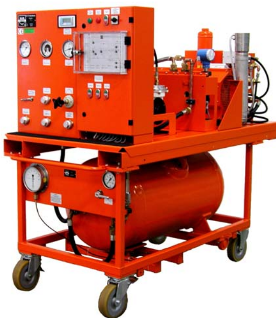
Установка В120R21 с емкостью для хранения элегаза 300 л
