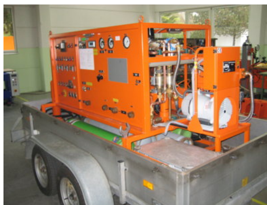
После модификации/ретрофита: сервисная тележка с безмаслянным откачивающим насосом откачивание газа < 1 мбар
