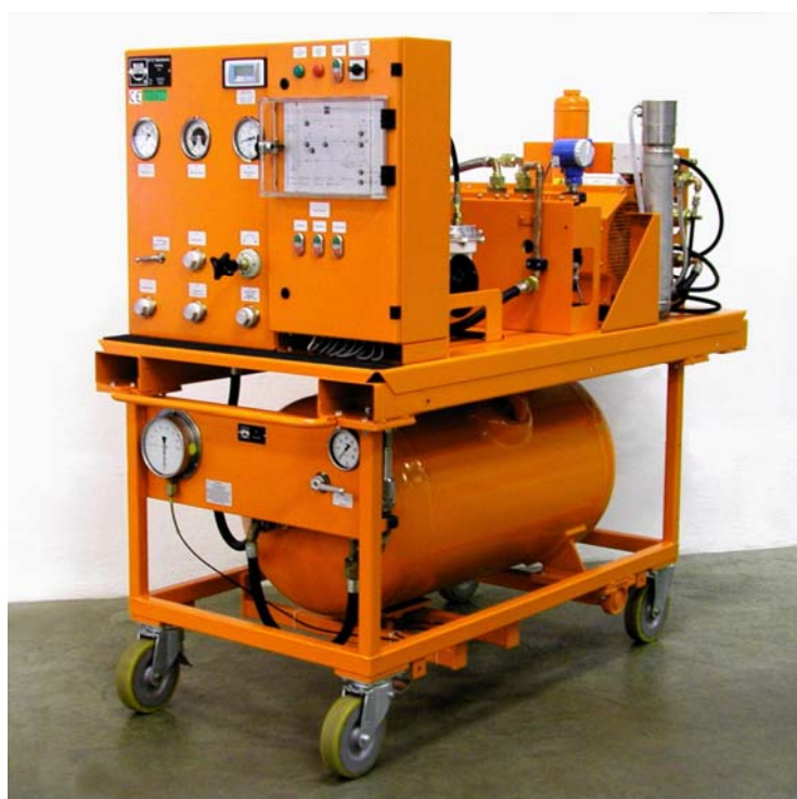
Установка В120R21 с емкостью для хранения элегаза 300 л
