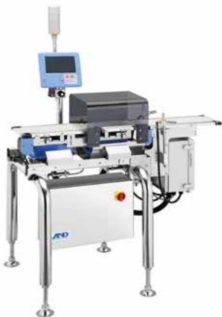
Данный тип оборудования предназначен для контроля веса продукции, движущейся по конвейеру и автоматической отбраковке упаковок с недо- или перевесом от заданного весового диапазона. Такая система контроля и учета на производстве позволяет контролировать процесс и не допускать выхода с линии бракованной продукции. По многим международным стандартам качества (HASSP, GMP, IFS, ISO) это оборудование обязательно для применения и является контрольной точкой при выпуске продукции.
