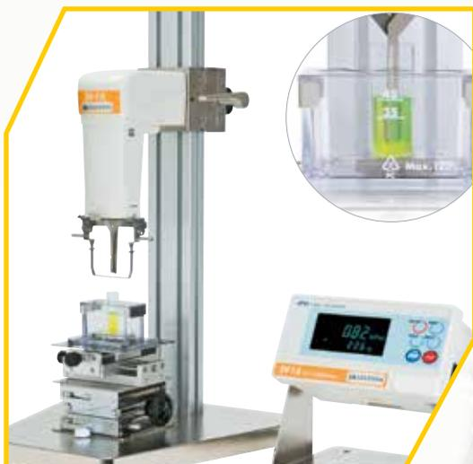
Вискозиметры от A&D – это революционный прорыв в технологии измерения вязкости. Благодаря использованию метода камертонной вибрации вискозиметры SV и SV-A приобрели ряд преимуществ, которые выгодно отличают их от традиционных ротационных вискозиметров
