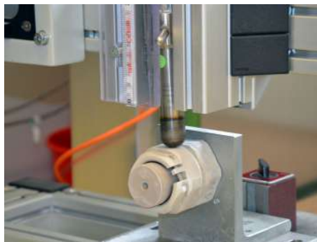
Schlagprüfung / Impact resistance
