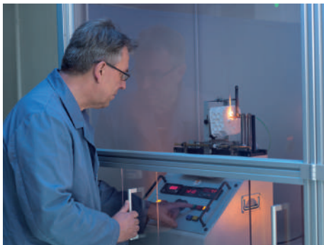
Glühdrahtprüfung / Glow wire resistance
