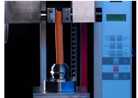
Zugprüfung / Tensile resistance
