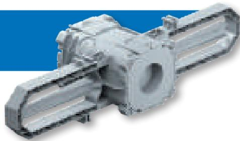
Einlasskasten mit Prefix®-Montagetechnik, für die einfache und schnelle Installation zur Gegenschalung ohne Abstützung. Die einteilig ausgeführte Dose mit zwei integrierten Frontteilen bietet Dank der federnden Montageklappen hohen Druck auf die Gegenschalung und sorgt somit für den exakten Sitz der Dose und ein sauberes Wandbild.
