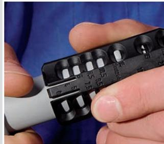
Rastknopf eindrücken. Griff drehen und auf gewünschte Position schieben, bis die Pfeilspitze in der Öffnung sichtbar ist. Griff zurück drehen und einrasten.
