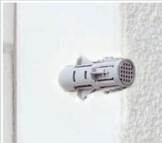
Durch das Eindrücken des Befestigungskerns werden die Schwenkschneiden in dem Dämmmaterial verankert und geben dem Mini-Geräteträger sicheren Halt.
