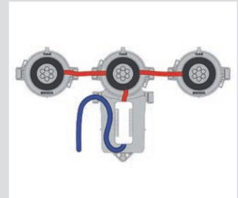
Schematische Darstellung Gruppenschaltung mit einem Betriebsgerät.
