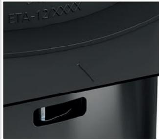
Markierung für die Positionierung der Laschenschrauben.
