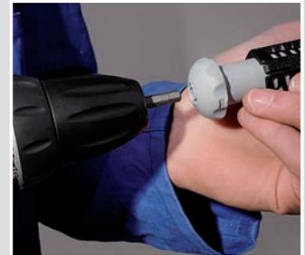
TIPP: Um mehrere Öffnungen zu schneiden oder harten Kunststoff zu bearbeiten, können Sie den Öffnungsschneider auf den 1/4"-Bit eines Akkuschraubers aufsetzen.
