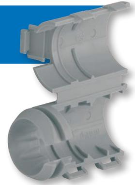
Rohrstopper zur sicheren und genauen Positionierung von Installationsrohren in Einbaugehäusen. Verhindert das zu weite Einführen der Rohre und sichert diese gegen Herausrutschen auch bei extremer Belastung.
