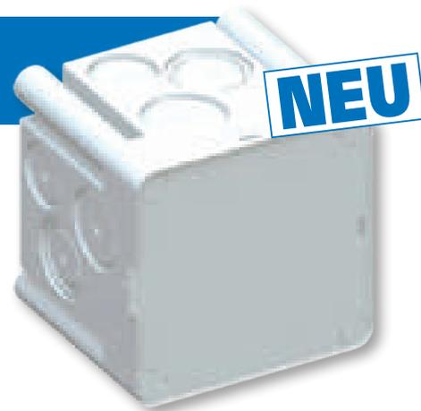
Die halogenfreien Einlasskästen für die Hohlwand sind für die Montage auf brennbaren Materialien geeignet. Die Dosen sind in weissem Polypropylen gefertigt und haben die Glühdrahtprüfung bei 850°C nach EN 60695-2-11 erfolgreich bestanden.
