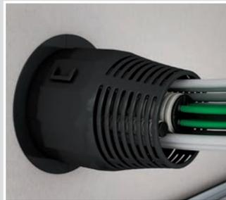
Zweiteiliges Dichtelement um das Bündel legen, verschließen und über den Bajonettverschluss mit dem Schottzylinder verbinden.
