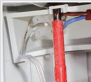
Mit einem Schraubendreher oder einer Spitzzange kann die Verschlusskappe auch nach dem Einbau herausgehoben werden, um das Betriebsgerät zu warten.
