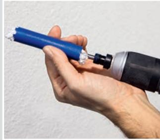
Durch einfaches Abschrauben der Fräskrone lässt sich der Bohrkern mittels Zentrierbohrer schnell entfernen.
