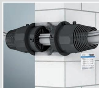
Dichtelement auf den Schottzylinder setzen und mit einer ¼-Drehung befestigen (Bajonetverschluss).
