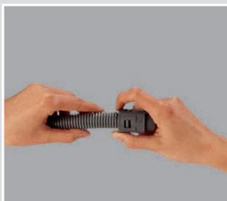
**1** Die Demontage des Wellenschlauches erfolgt durch Andrücken des Bundes der Rasthülse an den Verschraubungskörper.
