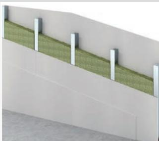
Aufbau einer F90 Metallständwand nach DIN 4102 Teil 4
