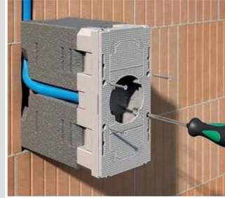
Für die Befestigung grosser Lasten empfiehlt es sich, die Montageplatte mit Schrauben M3.5x25 zusätzlich zu sichern.
