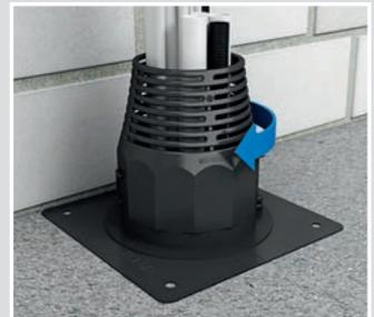
Dichtelement umlegen, verschliessen und durch eine 1/4-Rechtsrotation fixieren.
