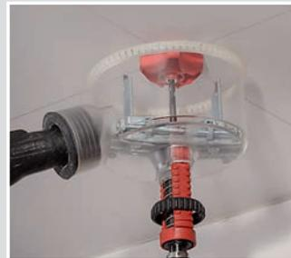
VARIOCUT mit Zentrierbohrer aufsetzen. Anbohren, das Schutzgehäuse plan aufsetzen und mit leichtem Druck Öffnung schneiden.
