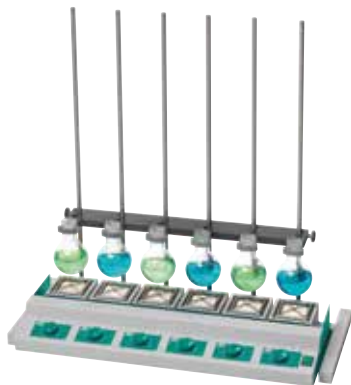
IRB 6 mit Stativgestell, PVC-Schiene und Halteklammern IRB 6 with support base, horizontal PVC rod and clamps for PVC rod
