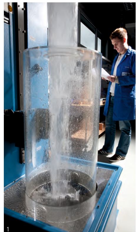
Abb. 1 – PFLITSCH-Wasserschutzprüfung IP X6 Fig. 1 – PFLITSCH water ingress protection test IP X6
