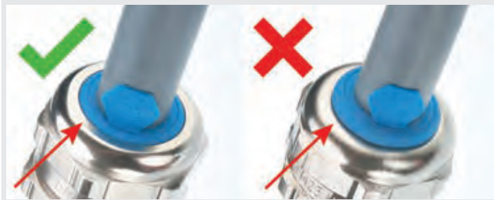
Abb. 1 – Druckschraube anziehen, bis Dichteinsatz und Druckschraube auf einer Höhe sind Fig. 1 – Tighten the pressure screw until pressure screw and sealing insert are at the same level.
