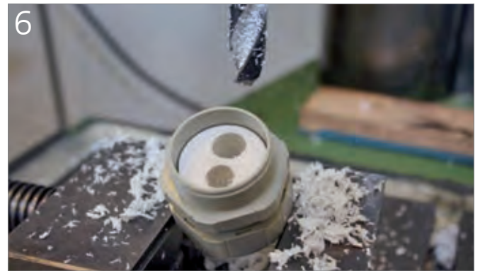
6 Zweite Bohrung in der Ansicht von unten
