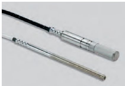
РТУ307 обогреваемая измерительная головка для ответственных метеорологических установок
