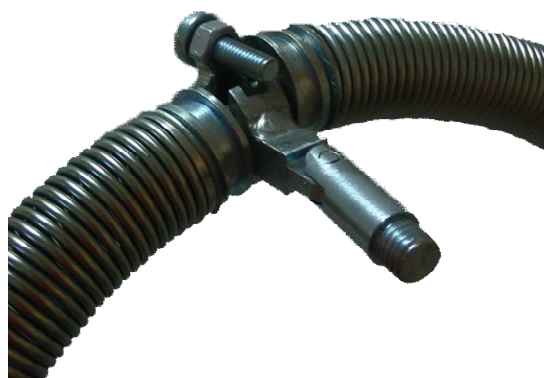
Рис. 22. Подготовленный к проведению контроля пружинный электрод
