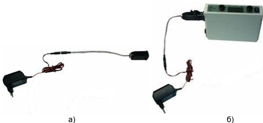
Рис. 27. Заряд аккумулятора в блоке контроля: а) подсоединение соединительного кабеля к переходному разъему; б) подсоединение выходного кабеля зарядного устройства к разъему «X1» блока контроля
