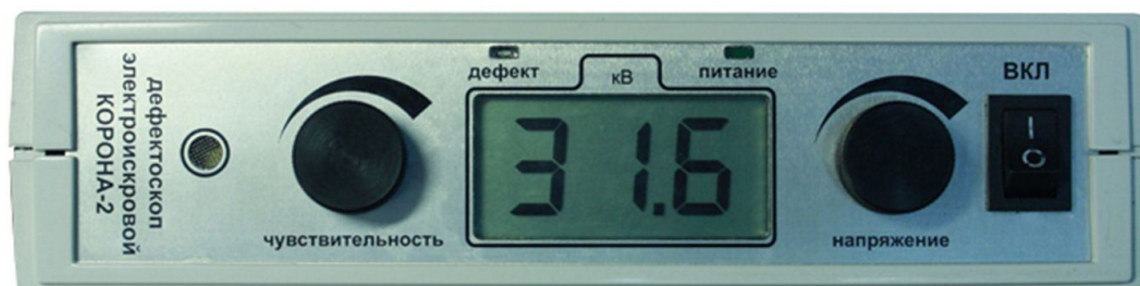
Рис. 3. Внешний вид органов управления, регулировки и индикации прибора
