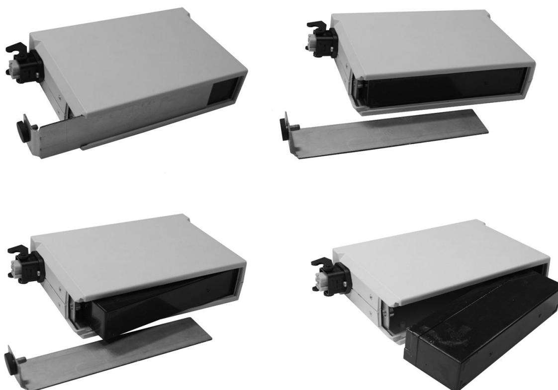
Рис. 29. Последовательность действий при замене аккумулятора
