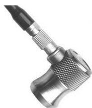
**Прямые совмещенные** ПЭП используют для дефектоскопии и измерений толщины ОК относительно больших толщин.
