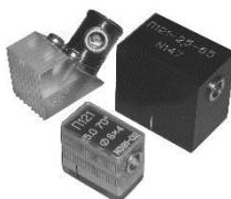
**Наклонные** ПЭП используют для дефектоскопии ОК и их фрагментов в местах, где отсутствует доступ к поверхности над зоной контроля.
