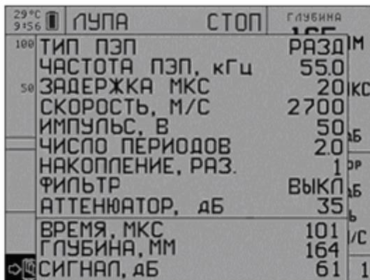
Рис. 3.11 Экран прибора в режиме СТОП при использовании режима "ЛУПА" с выводением на экран основных параметров
