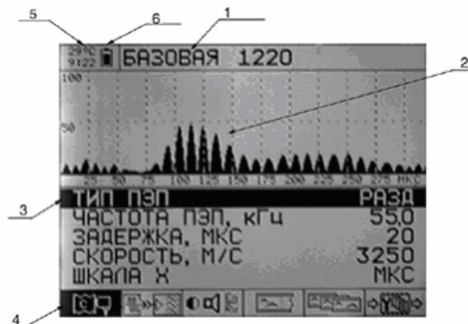
**Рис. 3.3** Экран прибора в режиме МЕНЮ (1 – название конфигурации; 2 – область представления осциллограмм; 3 – редактируемый пункт меню; 4 – выбранный раздел меню; 5 – температура внутри прибора; 6 – индикатор уровня заряда)
