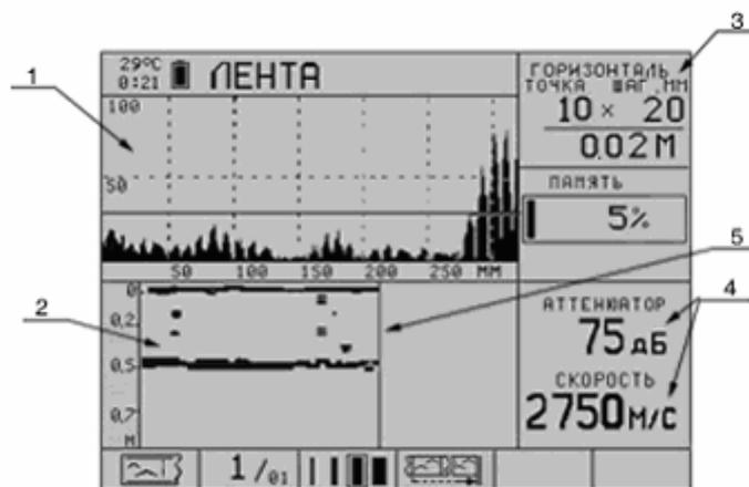
**Рис. 3.7** Экран прибора в режиме ЛЕНТА
