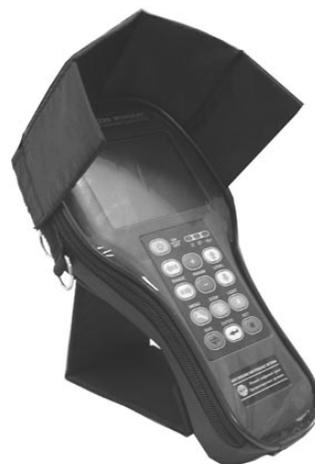
**Рис. 2.3 Использование бленды для устранения бликов на защитном стекле.**
