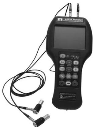
Преобразователи с СТК подключаются к прибору двумя одинарными кабелями LEMO-LEMO к соответствующим разъемам прибора.
