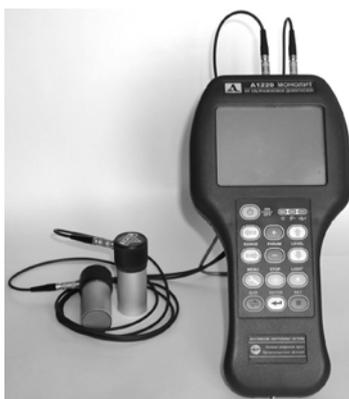
Преобразователи подключаются к прибору двумя одинарными кабелями LEMO-LEMO к соответствующим разъемам прибора.
