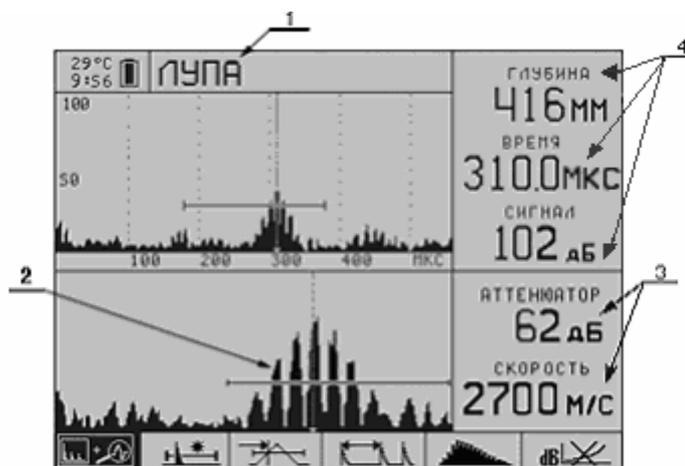
**Рис. 3.6** Экран прибора в режиме ЛУПА
