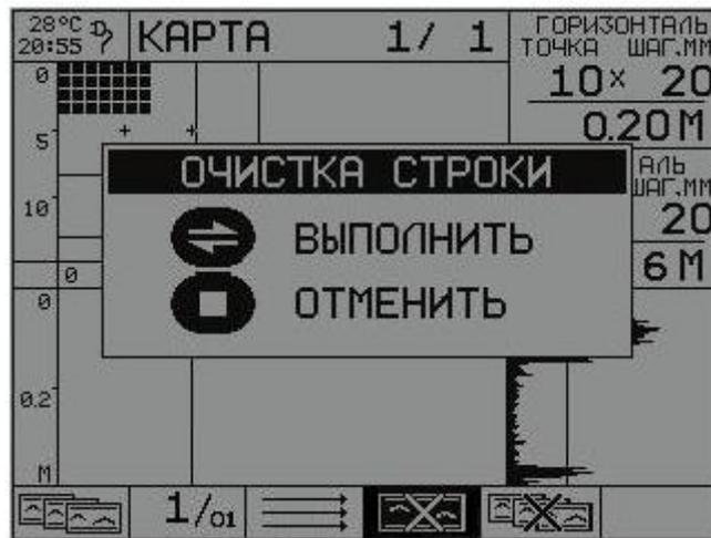
Рис. 3.9 Экран прибора в режиме КАРТА при включенной пиктограмме очистки строки
