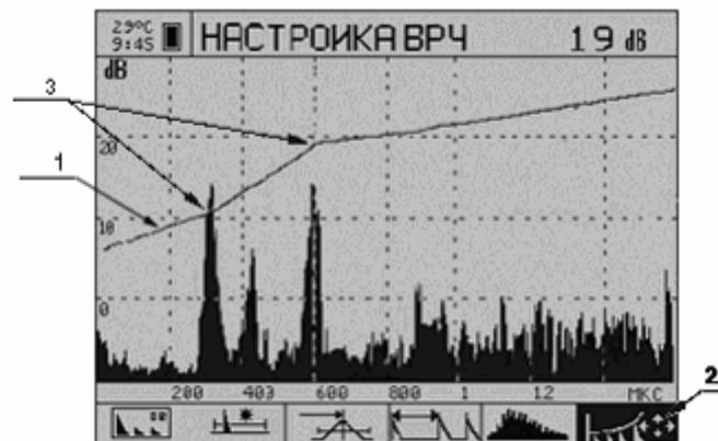
**Рис. 3.5** Экран прибора при настройке ВРЧ.
