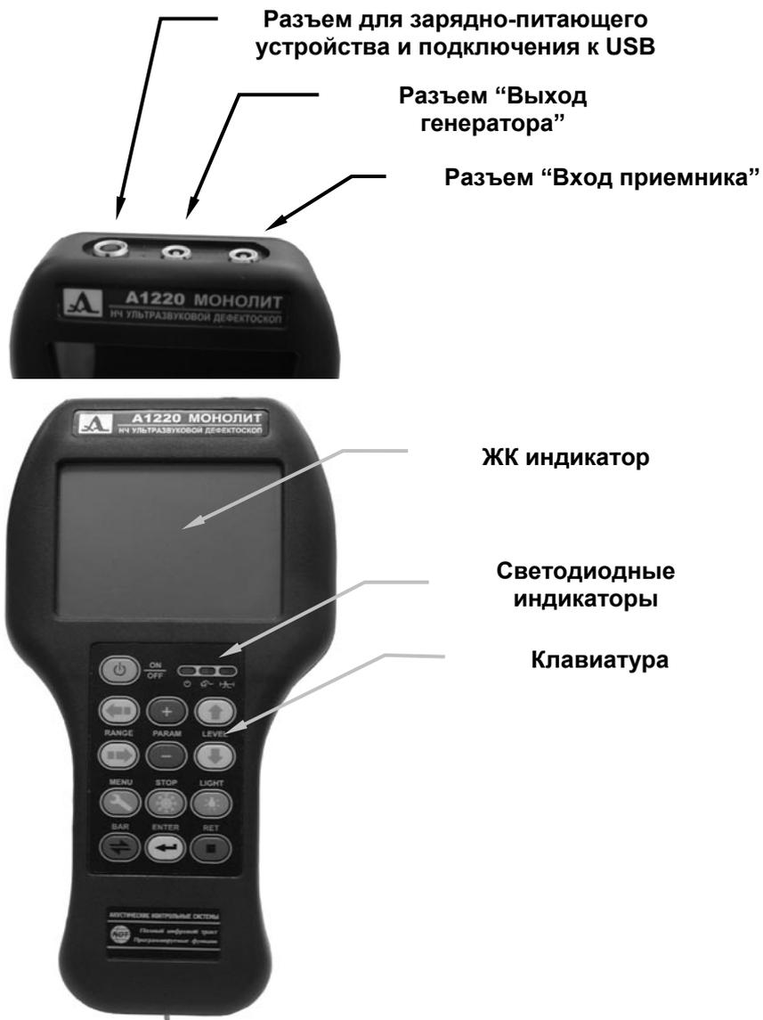
**Рис. 2.1. Электронный блок дефектоскопа**
