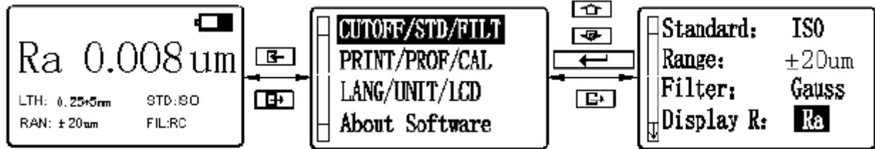
Рисунок 2-13 Установка отображаемых параметров
