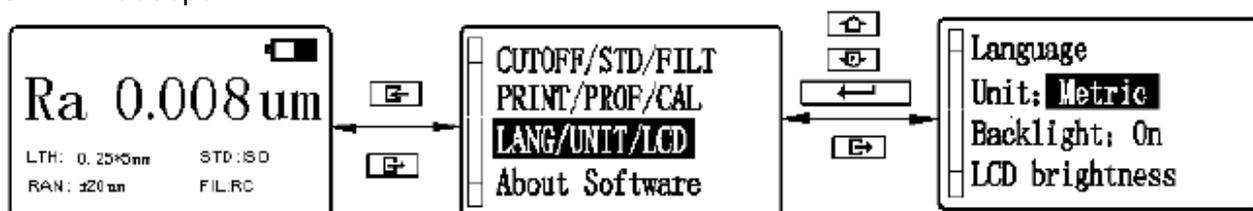
Рисунок 2-16 Выбор между метрической и британской системой единиц измерения
