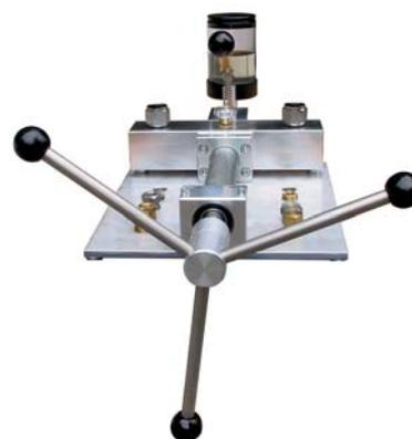
С целью нагнетания давления точной величины тестовые насосы **LR-Cal LSP** оснащаются колесом точной настройки. Кроме этого, приборы серии **LR-Cal LSP** обладают резьбовым шпинделем, перемещающимся исключительно в пределах корпуса прибора. Это обеспечивает отсутствие изгибающего момента у выпирающего стержня шпинделя, а также делает габариты инструмента неизменными во время использования. Насос требует приложения лишь небольших усилий для нагнетания давления.
