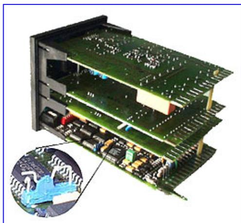
Кроме коррекции измерений (компенсации погрешности датчиков и погрешностей, вносимых соединительными проводами) входные и выходные сигналы могут быть масштабированы для вывода на индикатор реального значения параметра, также линеаризованы или математически обработаны (извлечение корня). Регулятор KS 94 позволяет приспособляться к технологическому процессу без дополнительных приборов. На практике бывает оправдана искусственная подача помехи для улучшения регулирования, например, паровых котлов.
