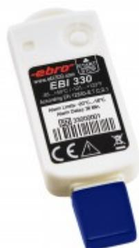
Одноразовый регистратор температуры EVI 330-T85 с USB-интерфейсом необходим для проверки на соответствие температуры необходимым параметрам во время транспортировки и хранения необходимо для обеспечения безопасности и сохранности качества продукции, чувствительной к изменениям температур.
